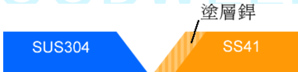
圖 4 厚板的異材接頭施工案例
