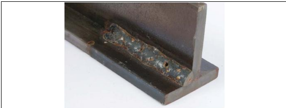
圖 1 GMAW 很典型的氣孔缺陷，提高遮護氣體流量或檢查管線是否洩漏可改善此問題
